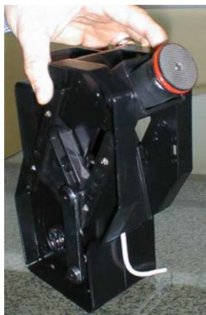
Повернуть верхний фильтр вверх, снять его и промыть горячей водой, удаляя с него кофе
